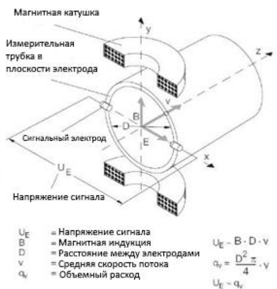
Схема электромагнитного расходомера
